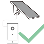
Varmistetaan, että virtakaapeli on luonnollisesti ilman jännitystä
